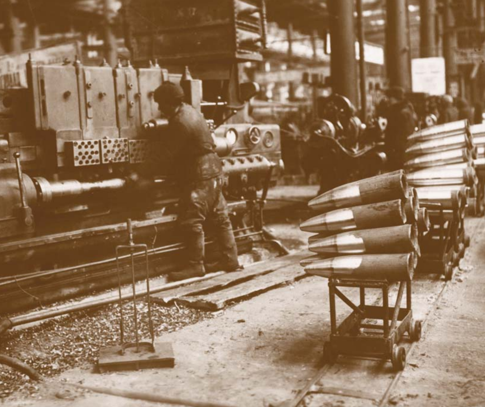
Поточное производство на заводе № 65 им. Сталина. Производство 132 мм ракетного снаряда. Общий вид потока механической обработки головки. ГАНУ. Ф. П-11796. Оп. 1 к. Д. 238. Л. 10 об.
